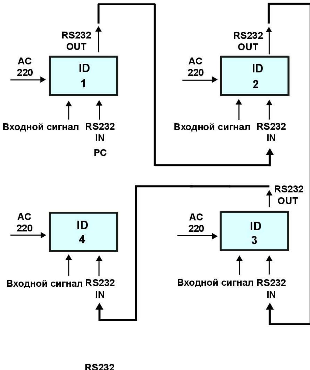
**Блок-схема видеостены (2 x 2)**
