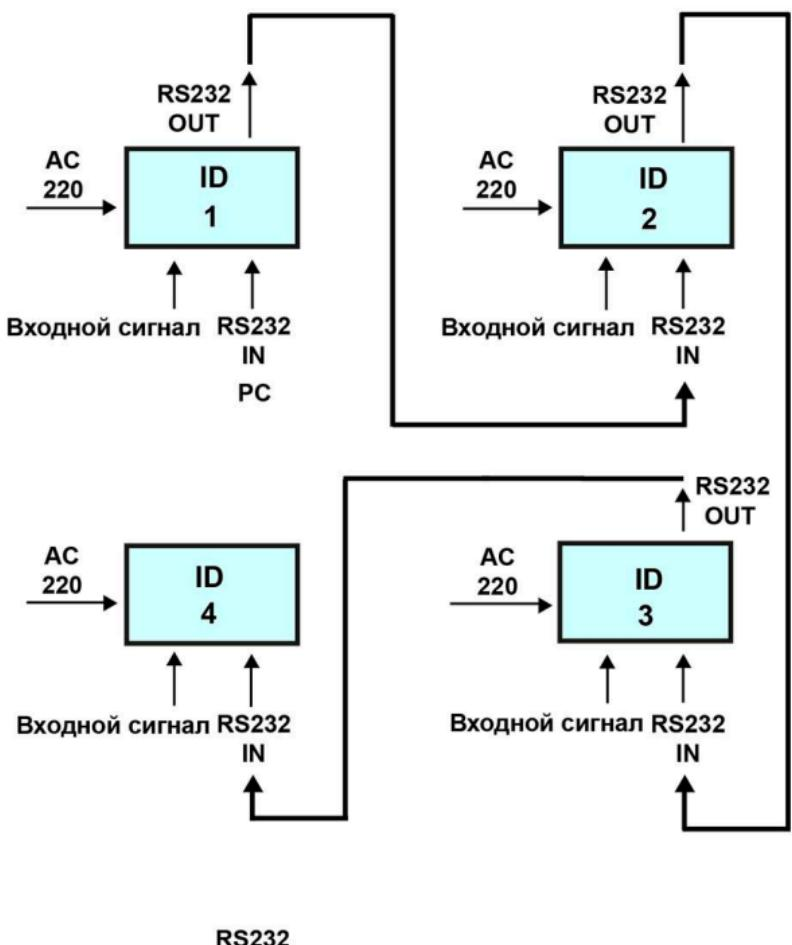
*Блок-схема видеостены (2 x 2)*
